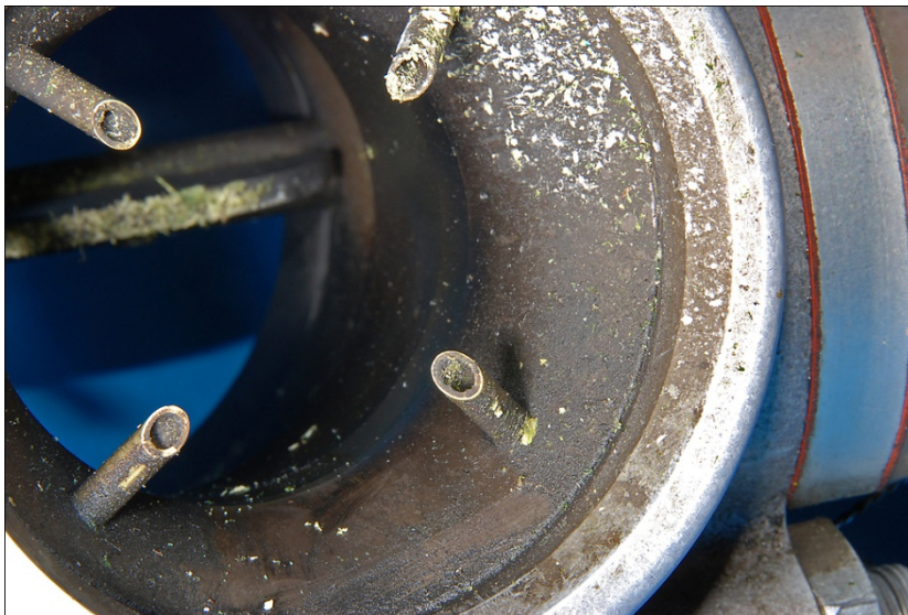
Bild 4 Öliges Belag und pflanzliche Partikel am Lufteintritt des fuel injection servo und auf der Kante der Drosselklappe.
