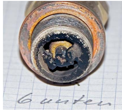
Bild 2 Untere Zündkerze von Zylinder 6 mit Kohlefäden zwischen der Mittelelektrode und beiden Masseelektroden.
