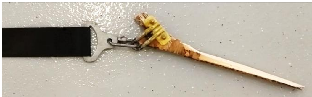
Figure 6 : segment de la fixation en bois détaché de la structure de l'avion avec la ceinture de sécurité sous-abdominale du siège arrière droit et assemblage vissé intact
