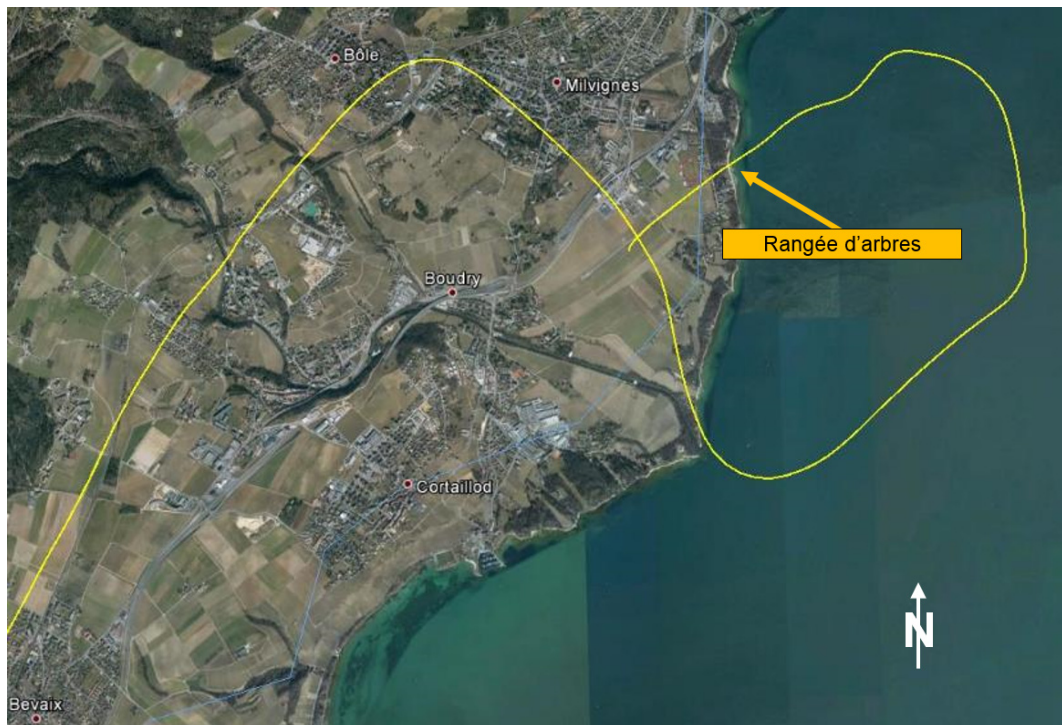
Figure 1 : trajectoire du vol lors de l'approche sur l'aérodrome de Neuchâtel (LSGN). La position de la rangée d'arbres identifie l'endroit où une augmentation de puissance a été nécessaire pour contrer les vents rabattants générés par celle-ci.
