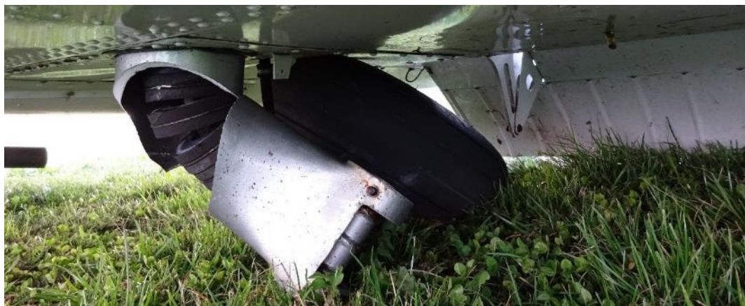
Figure 6 : vue du train d'atterrissage gauche après la sortie de piste
