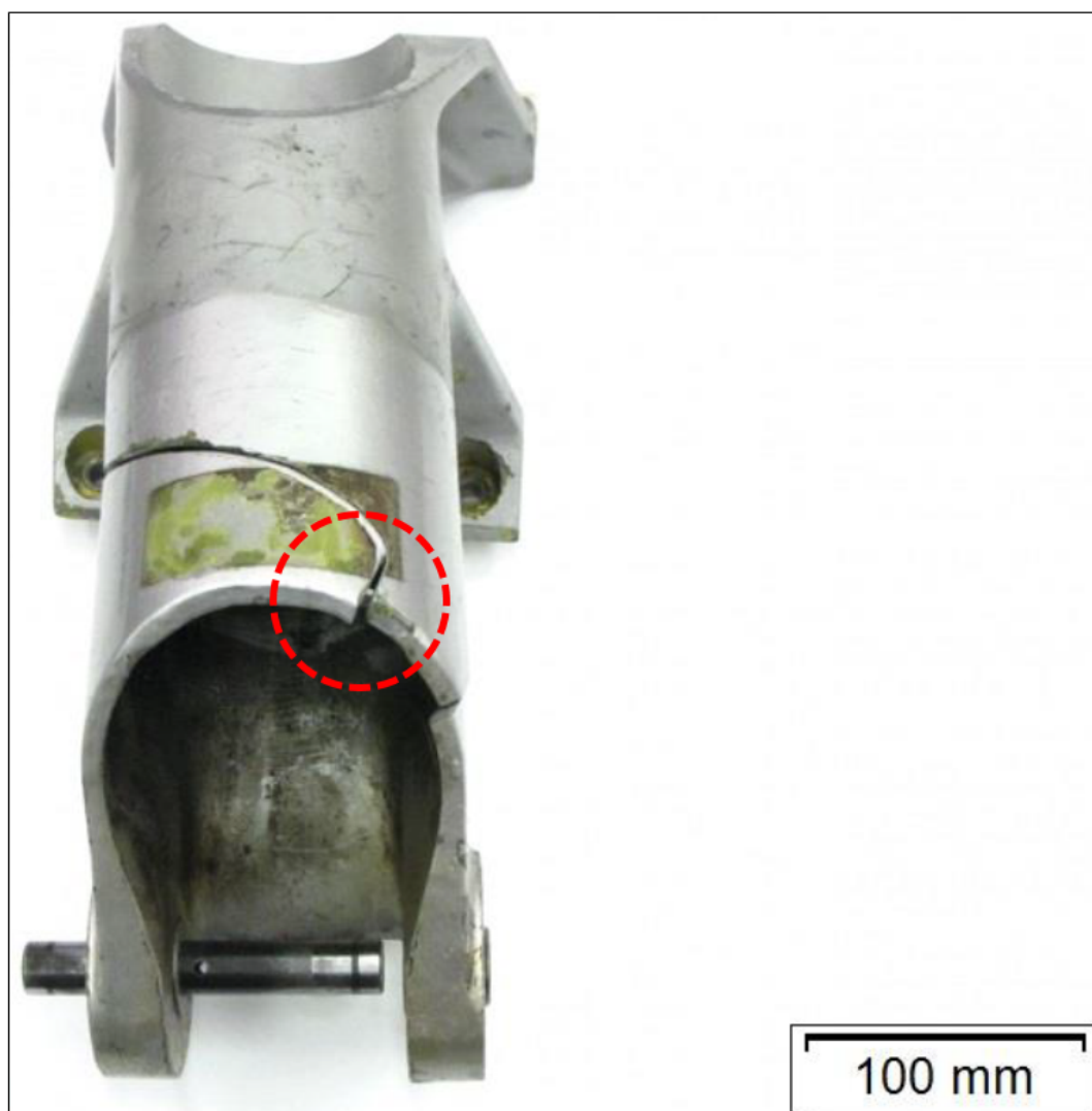
Figure 7 : visualisation du tube principal avec la rupture
